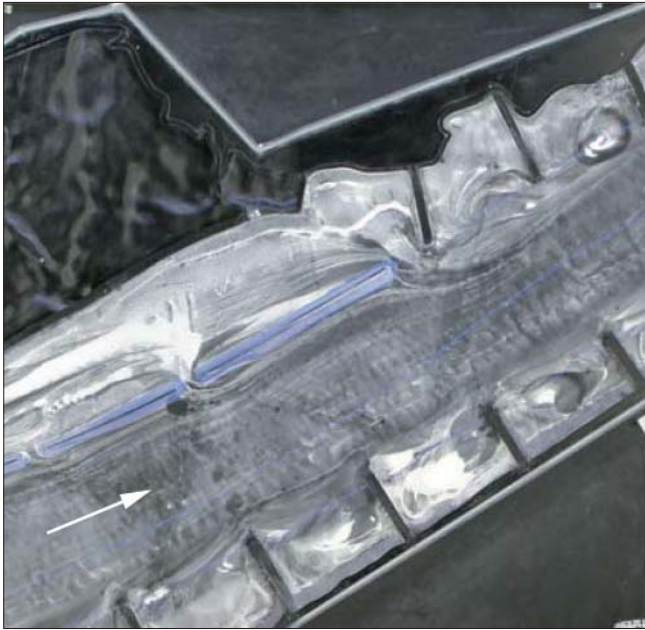
Bild 17: Oder bei Reitwein-Kietz: Erosionsverfahren – Bereich am Ende des Parallelwerks, Bauwerke umströmt
