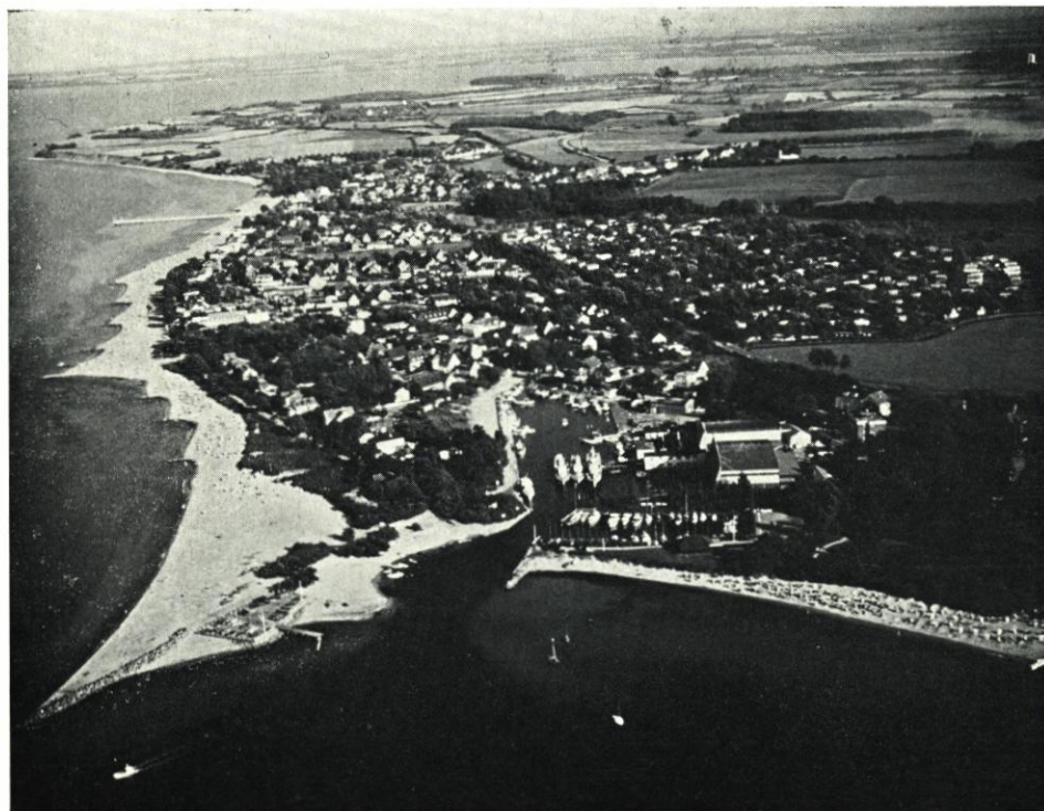
Abb. 9. Fischer- und Sporthafen in der Lübecker Bucht. Die Hafensemole unterbricht die natürliche Sandbewegung und erzeugt eine Lee-Erosion
