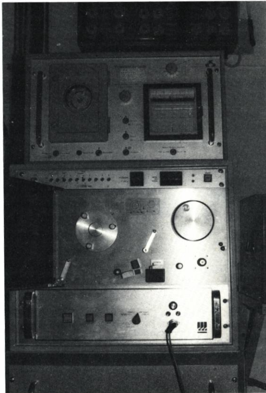
Abb. 3.5 Empfangsstation mit AD-Wandler und Magnetbandgerät
