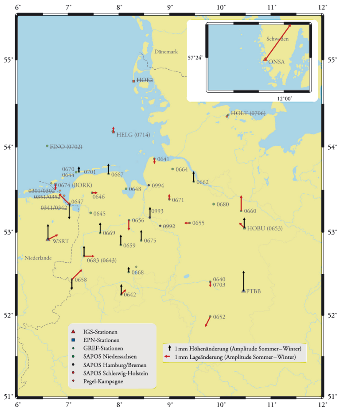
Abb. 7: Jahreszeitliche Änderungen der GPS-Stationen auf der Grundlage der relativen Residuen (zur Station 0648). Durchgestrichene Stationsnamen kennzeichnen Stationen, für die eine Schätzung aufgrund der Datengrundlage nicht möglich war
