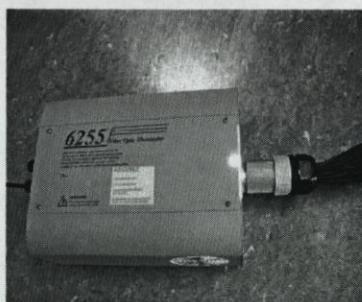
Abbildung 1: Reflektorlampe mit Faserbündeln und Schutzschlauch münden in den Wasserstrahler mit Linse.
