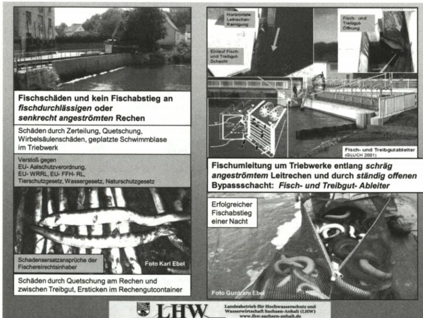
Abbildung 5: Praxiserprobe Alternative zu Fischschäden und fehlendem Fischabstieg an herkömmlich senkrecht angeströmten Rechen: Fisch- und Treibgutableiter
