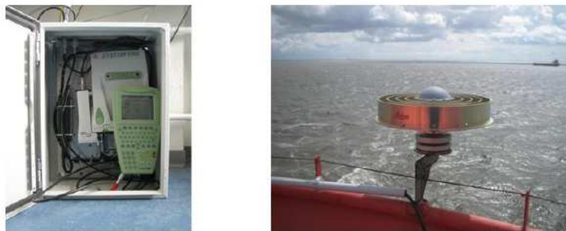
Abb. 2-2: Leica GRX1200+ GNSS Receiver mit Controller (links) und Leica AT504GG Antenne mit Bämpfer Dreifuß (rechts)
