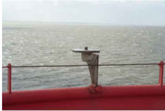
Abb. 2-11: Konsole für die Aufnahme einer GNSS-Antenne
