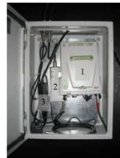
Abb. 2-13: Leica GRX1200+ GNSS (1), GFU24 (2), Netzteil (3) und Zeitschaltuhr mit Schaltschrank der Station FLDW
