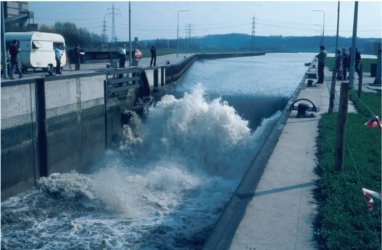
Bild 6: Hochwassersimulation an der Saarschleuse Lisdorf
