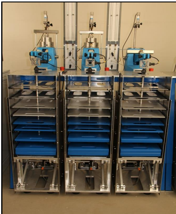
Bild 25: automatisierter KD-Stand des bodenmechanischen Labors der BAW-Hamburg
