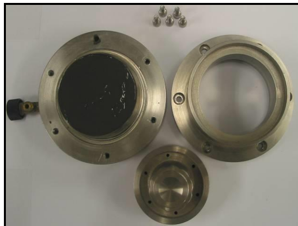
Bild 24: Oedometerzelle des bodenmechanischen Labors der BAW Hamburg
