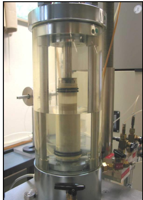
Bild 15: Triaxialprobe in der Zelle (Standard-triaxialgerät der BAW-DH)
