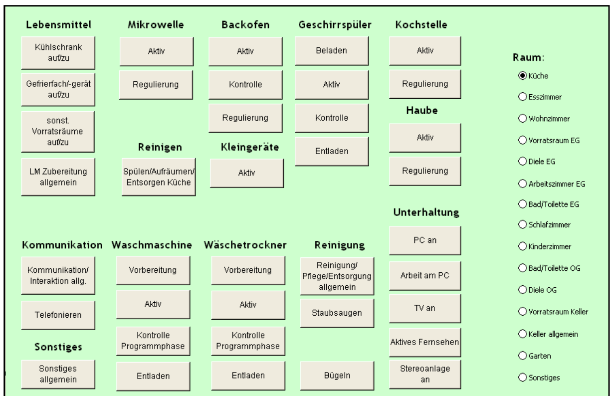
Abb. 12: Tablet PC Interface zur Erfassung von Tätigkeiten, Geräteaktivitäten, Aufenthaltsräume, Zeitpunkte und -dauern
