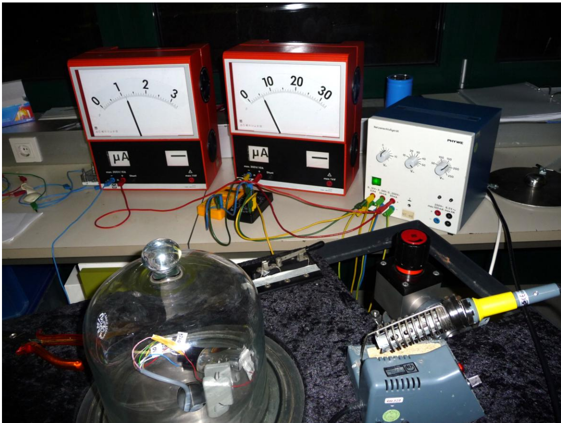
Abb. 6.4: Versuchsaufbau I_{\text{Anode 2}} (linkes Messgerät) I_{\text{Lochanode}} (rechtes Messgerät)
