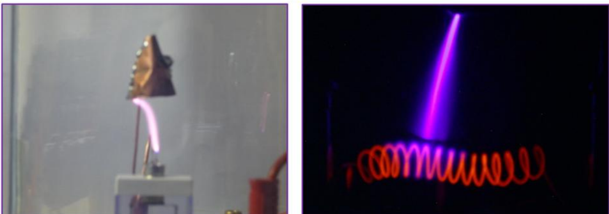
Abb. 2.1: Plasmaschlauchbildung infolge eines unzureichenden Vakuums
