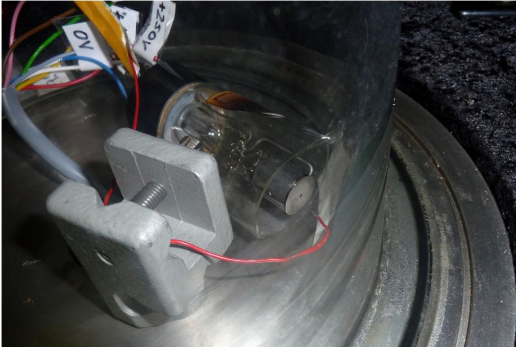
Abb. 6.5: Die Spitze des rot isolierten Drahtes dient als Anode 2
