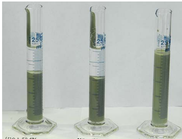
Abbildung 4-2: Verwendete Messzylinder zur Beurteilung der unterschiedlichen Sedimentationsstabilität der hergestellten Suspensionen. Alle Messzylinder sind mit ca. 25 ml Suspension befüllt.
