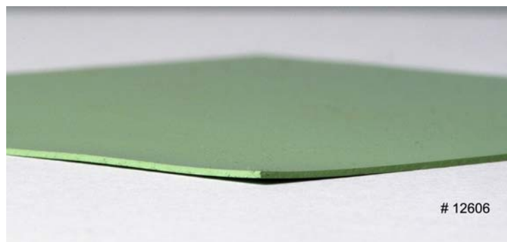
Abbildung 5-33: Aufgebogene Ecke eines Substrats Typ FG02 nach der Vorsinterung, hervorgerufen durch plastische Deformation im Grünzustand.
