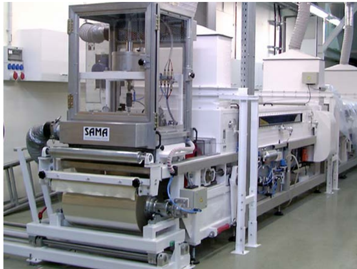
Abbildung 4-3: Foliengießanlage FGA500 am Institut für Energieforschung IEF-1.
