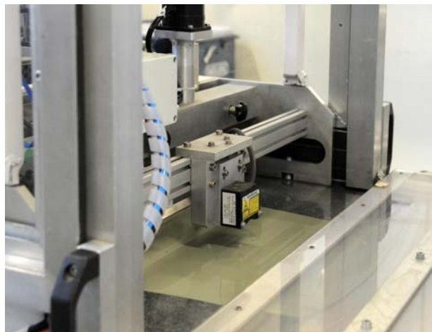
Abbildung 4-4: Lasergestützte Nassschichtdickenmessung nach der Formgebung an der Foliengießanlage FGA500.
