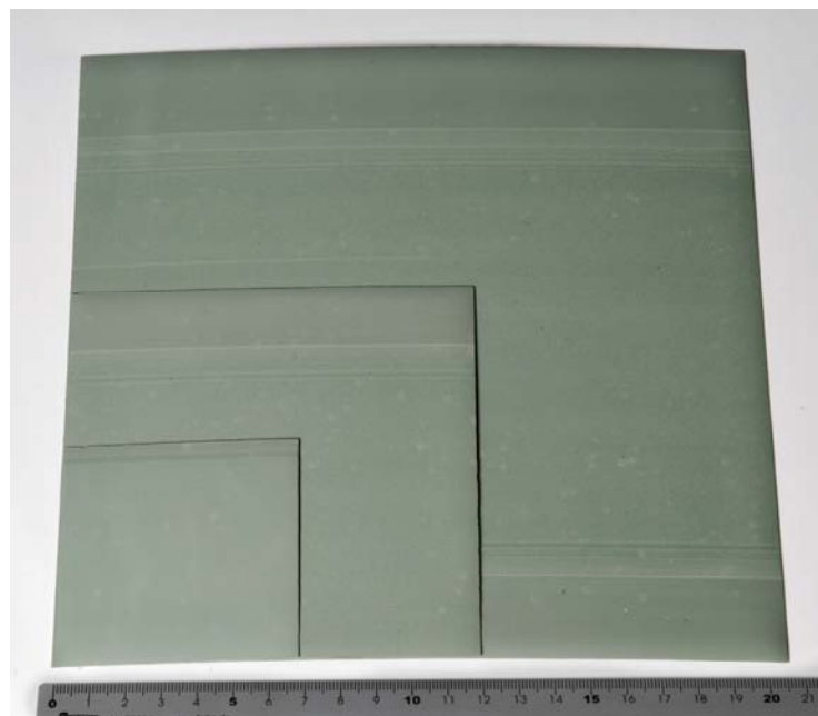
Abbildung 5-57: Foto von rein foliengegossenen Halbzellen Typ SFE30-1,5U in verschiedenen Formaten nach der Endsinterung bei 1400°C ohne Bügelschritt.
