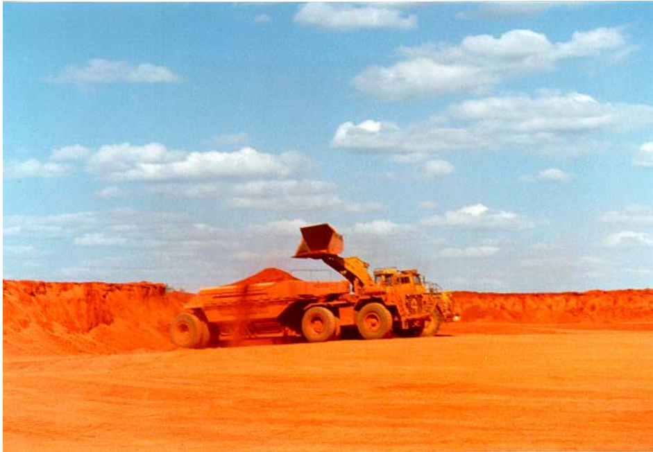
Bild 3: Laden des Wertminerals mittels Radlader auf 150 t SLKW [5]
