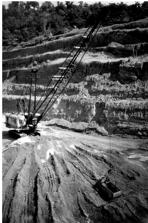
Abbildung 2: Einsatz eines Dragline am Standort Kirkvine
