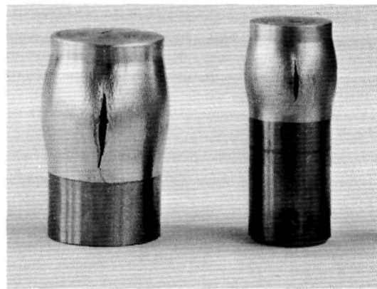
Abb. 6.7: Diffusionsverbindungen Edelstahl - AlMg3 nach der Berstprobe
