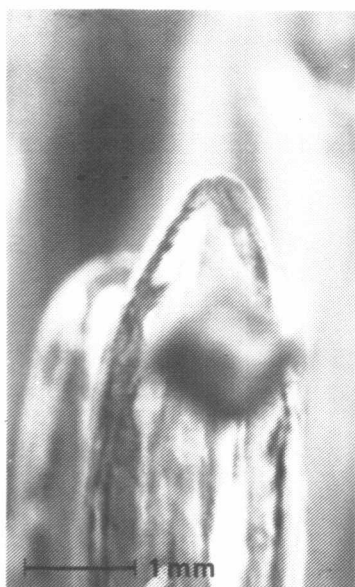
Bild XVIII zeigt analog strukturierte Köpfe längerer Lunker.
