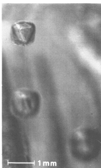
Bild XIX zeigt oben Facettenflächen kleiner Lunker, darunter deren beginnendes Einfallen zur Form links.
