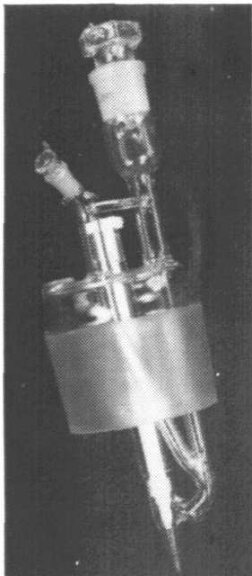
Bild VII: Spezieller Probenhalter, dessen unteres Meßröhrchen in einer Glove-Box mit nur einem Tropfen Meßsubstanz beschickt werden kann.
