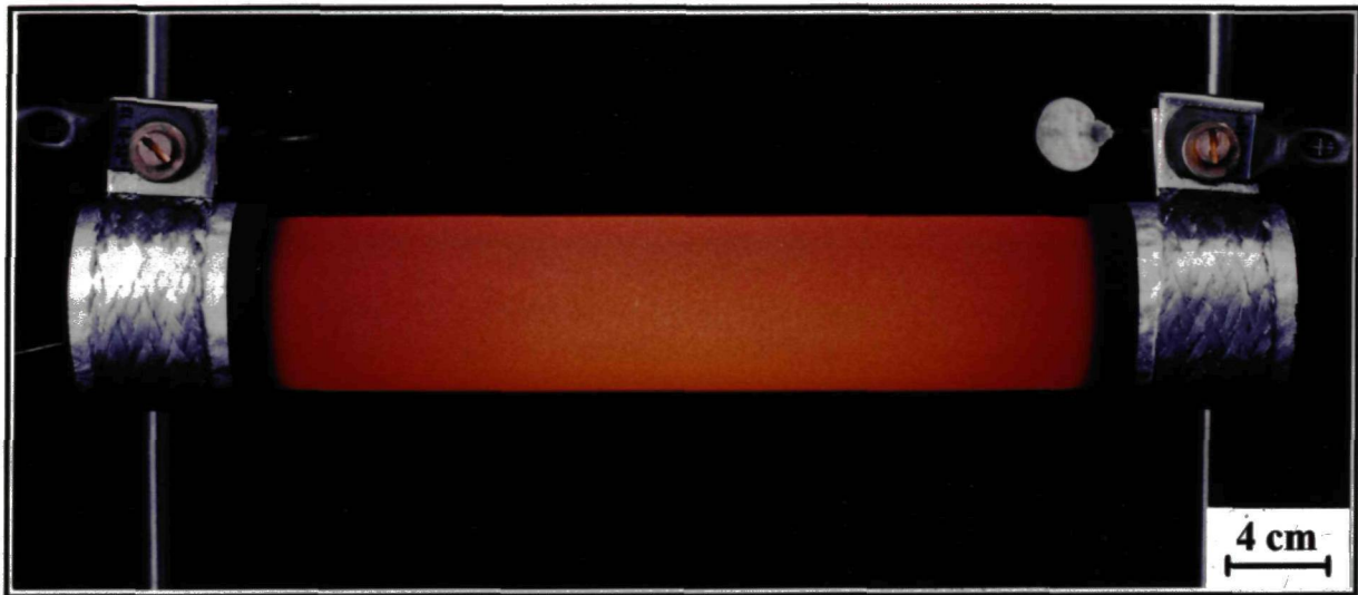
Abb. 1.3: Elektrisch regenerierbares CM-SiC-Dieselfußfilter
