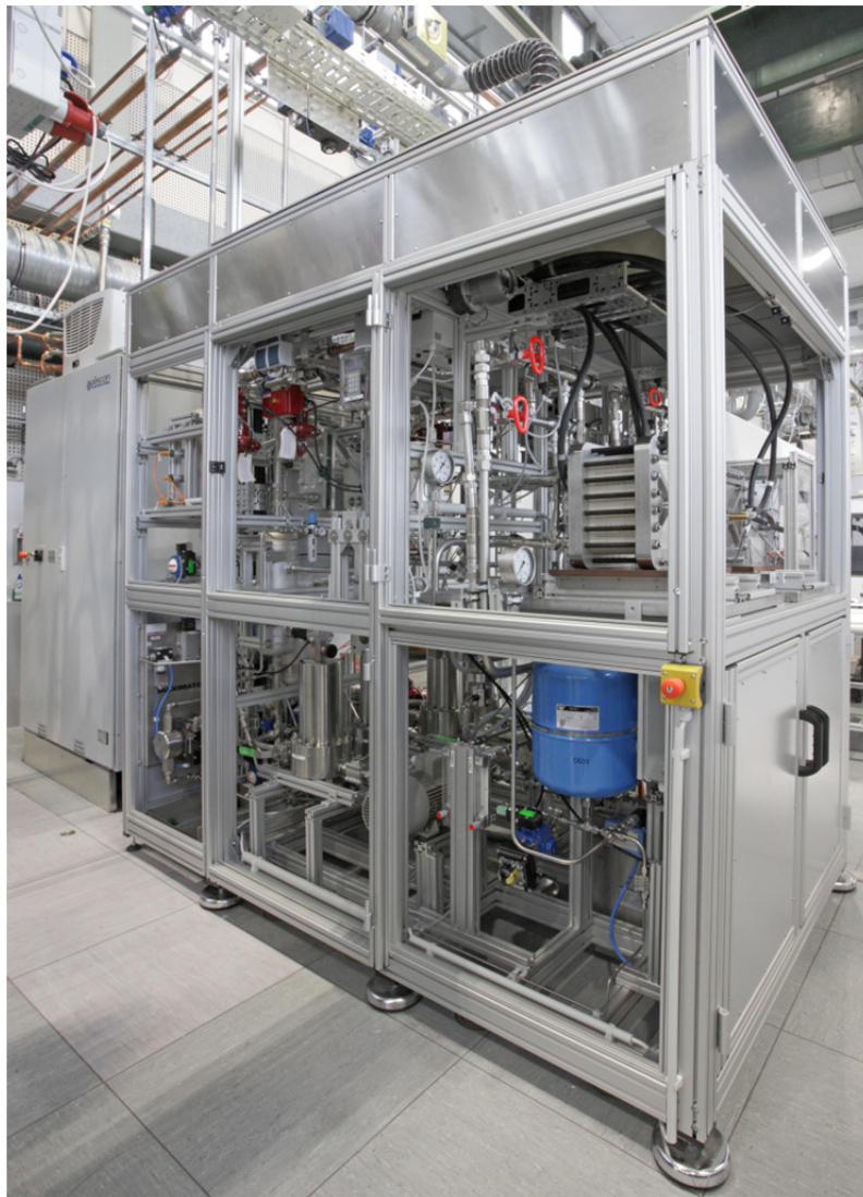
Abbildung 23: 100 kW PEM-Elektrolyseteststand des IEK-3
