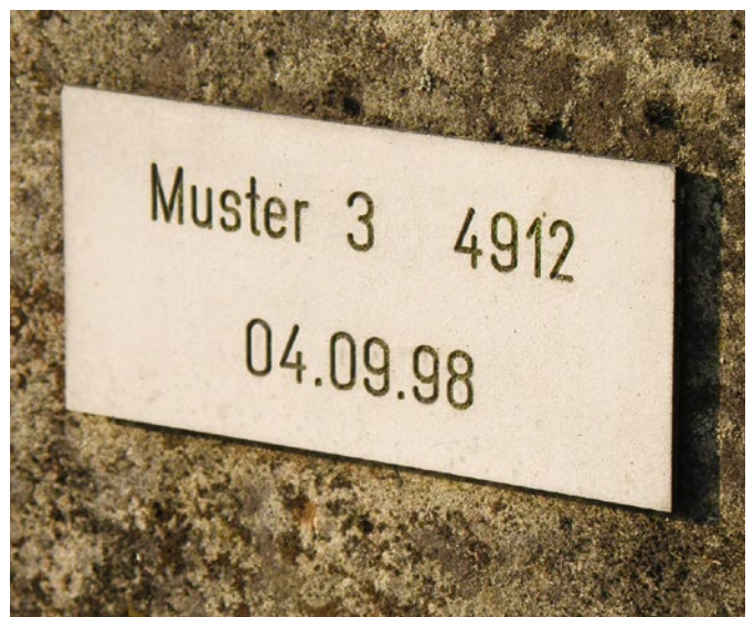
Outdoor-Test: Thermograv®-Schild seit 1998 Wind und Wetter ausgesetzt.
