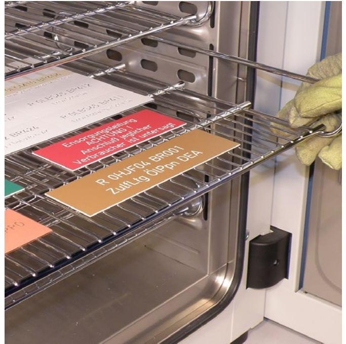
Hitzebeständig: Hitze-Test von Thermograv®-Schildern bei +135\text{ °C}
