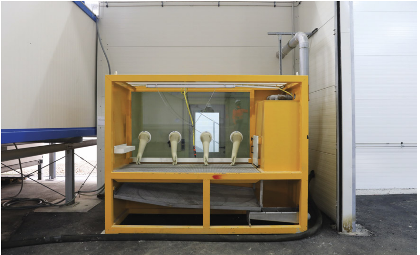
Abbildung 20: Im Schutze einer Glovebox wird das belastete Erdreich für die labortechnische Untersuchung vorbereitet (Aufnahmedatum: 9. November 2020)
