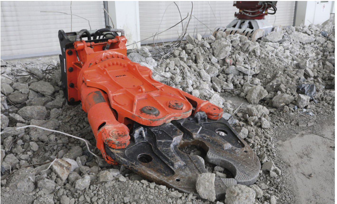
Abbildung 11: „Abbruchzange“ (Aufnahmedatum: 30. April 2020)
