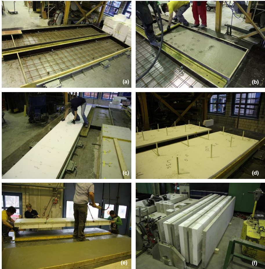
Abb. 2-5: Herstellung von Elementwänden mit integriertem Dämmstoff: Bewehren (a) und Betonieren (b) der FT-Vorsatzschale, Auflegen des Dämmstoffs (c), Installation der Verbindungsmittel (d), Bewehren und Betonieren der FT-Tragschale sowie Einwenden der FT-Vorsatzschale (e), stehende Lagerung nach der Herstellung (f)
