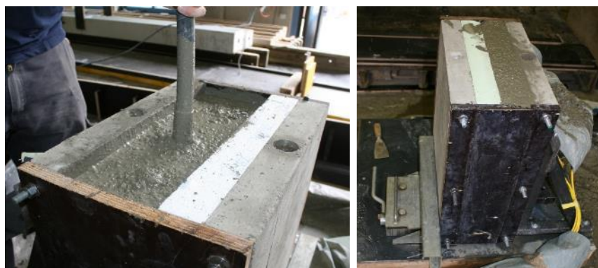
Abb. 3-6: Verdichtung des Frischbetons (links) und ausbetonierter Versuchsstand (rechts)
