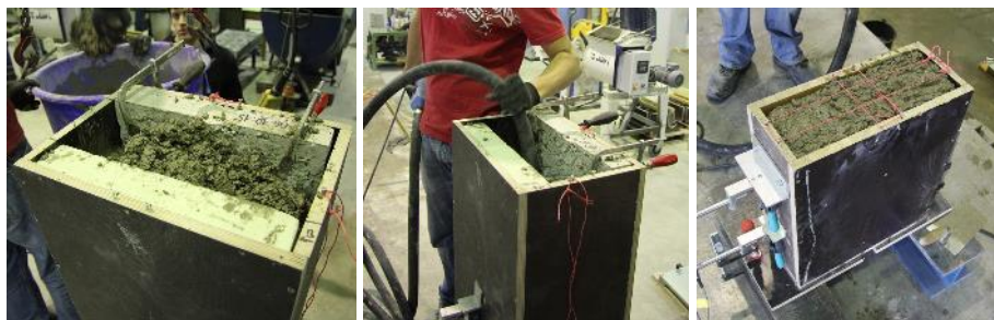
Abb. 6-14: Arbeitsschritte vor der Schwingungsmessung: Lagenweises Füllen (links) und Verdichten (mitte) des Frischbetons; Schalung bereit zur Messung (rechts)
