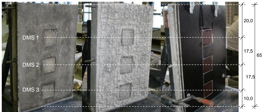
Abb. 3-5: Verschiedene Schalungsoberflächen (Beton rau (links), Beton verzahnt (mitte), Holz glatt (rechts)) und Position der Messstellen DMS 1 bis DMS 3
