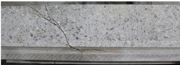
Abb. 4.62: Längsschnitte durch die Hochsicke des Versuchskörper C70-1,00-300-C30/37-Ø15/18hu-2
