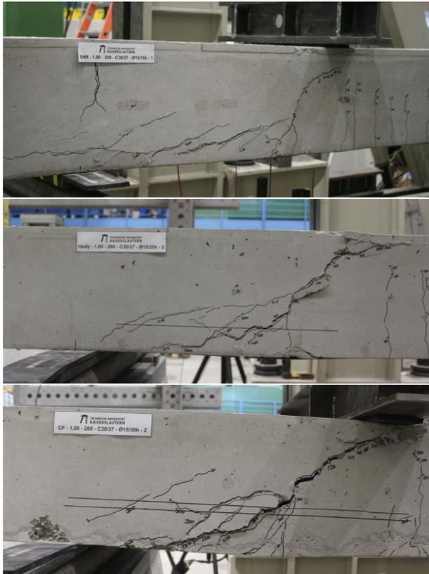
Abb. 4.43: Bruchbilder; oben: SHR-1,00-300-C30/37-Ø15/15h-1, mittig: Hody-1,00-280-C30/37-Ø15/20h-2, unten: CF-1,00-280-C30/37-Ø15/30h-2
