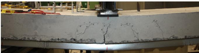
Abb. 4.7: Rissbild des Versuchs SHR-1,00-180-C20/25-Ø6/15-1
