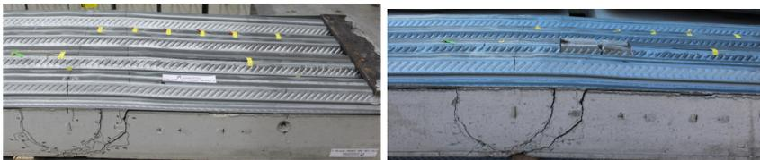
Abb. 4.38: Beulen im Verbundblech auf der Unterseite des Versuchskörpers C70-1,00-300-C50/60-Ø12/18-1
