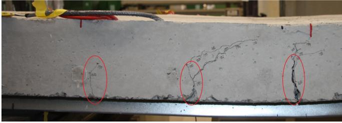
Abb. 4.8: Rissbild des Versuchs SHR-1,00-180-C20/25-Ø6/15-2
