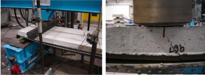
Abb. 4.68: links: Versuchsaufbau und rechts: Versagensbild des Versuchs L9 aus Stark u. Stark 2012
