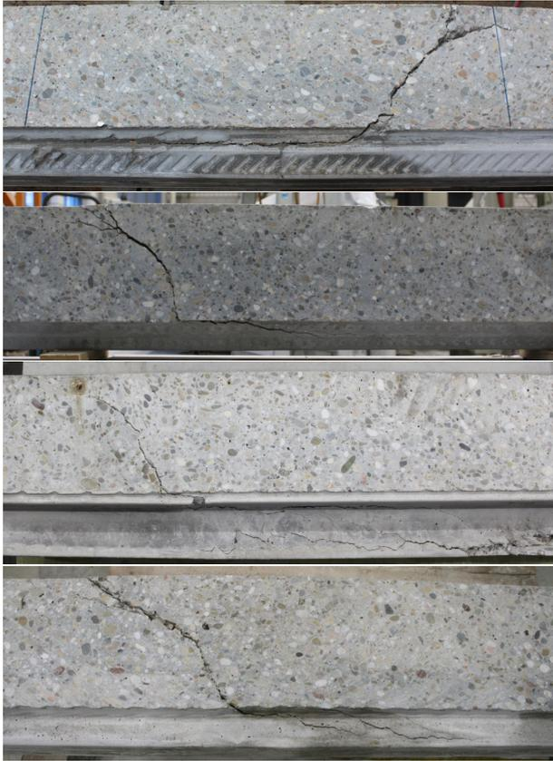
Abb. 4.61: Längsschnitte durch die Hochsicken der Versuchskörper; von oben nach unten: C70-1,00-300-C30/37-Ø15/18h-1, Hody-1,00-280-C30/37-Ø15/20h-1, CF-1,00-280-C30/37-Ø15/30h-1, SHR-0,75-250-C30/37-Ø15/15h-2
