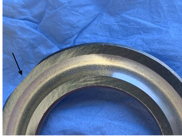
b) Identischer jedoch gereinigter Lagerring
