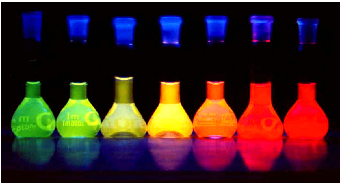
Abb.1-1: Fluoreszenz mehrerer kolloidaler CdTe-Proben unterschiedlicher Teilchengröße. Von grün bis rot ist hier die Farbe allein über die Partikelgröße einstellbar [Well2001].
