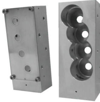
Abbildung 3.5: Detektorblöcke zur Aufnahme von je vier Detektoren (mit Messingblenden auf den Vorderseiten)
