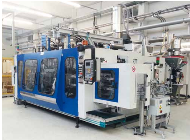
◀ Jede der Blasform-Maschinen ist mit einem gravimetrischen WSB-4-Komponenten Chargenmischer auf fahrbaren Mischertischen ausgerüstet.
