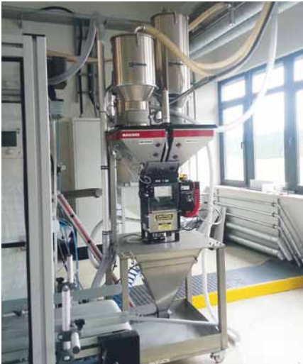
▲ Alle Mischer sind über das Intranet mit dem G2 Supervisory-System verbunden.
