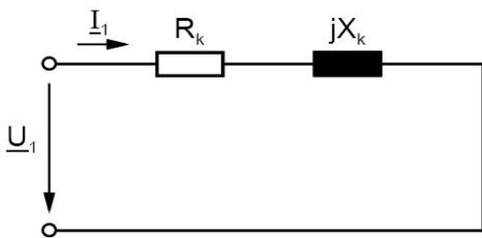
Spannung erhöhen bis Bemessungsstrom fließt. (für R und X)
