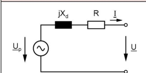
$U_p$  ... Polradspannung (vom Polrad in Ständerwicklung induziert; eingepreßte Spannung; Höhe über Erregerstrom einstellbar)
