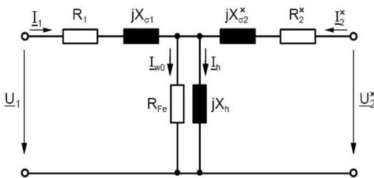
Bemessungsspannung an Primärseite anlegen und Leerlaufstrom messen. (Für  $R_{Fe}$  und  $X_h$ )
