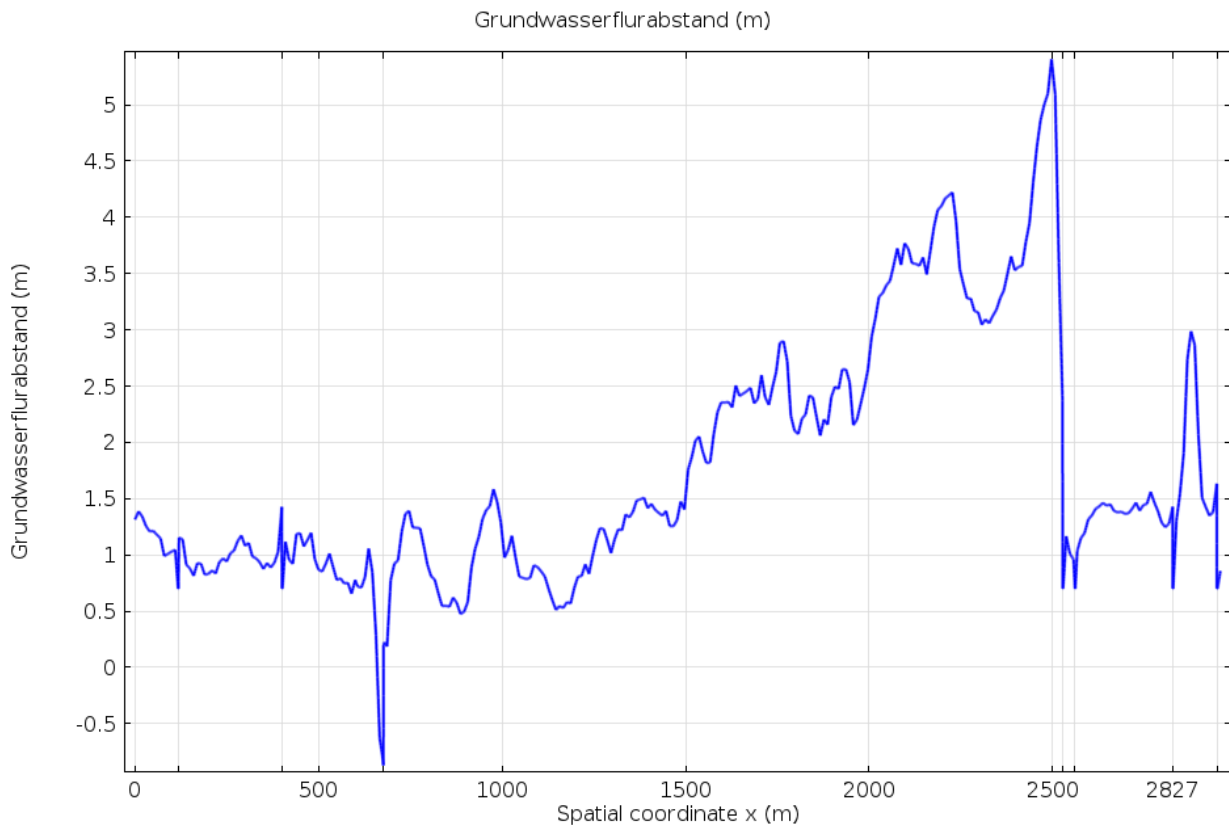
Abbildung 69: Grundwasserflurabstand bei quasi-stationärer Strömung im Szenario 1 für das Profil 5
