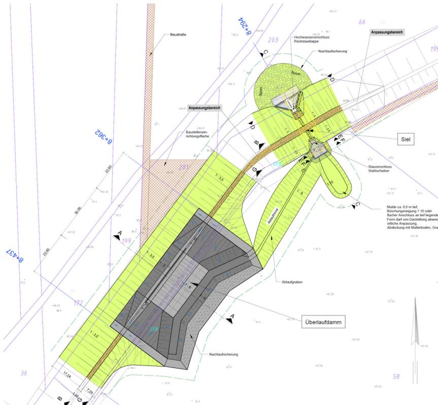
Abb. 3: Darstellung Draufsicht von Überströmstrecke und Sielbauwerk
