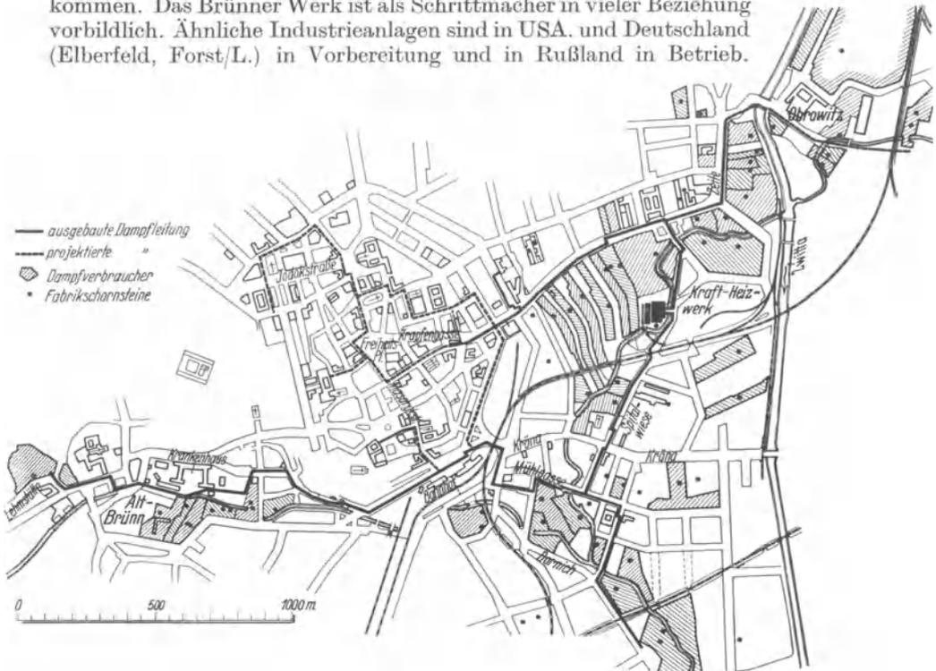
Abb. 64. Kraftheizwerk Brünn. Rohrnetz.
