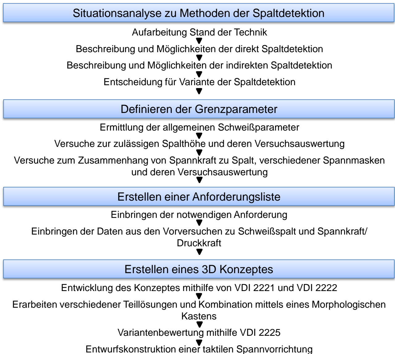
Bild 3: Vorgehen zur Konzeption einer taktilen Spannvorrichtung
