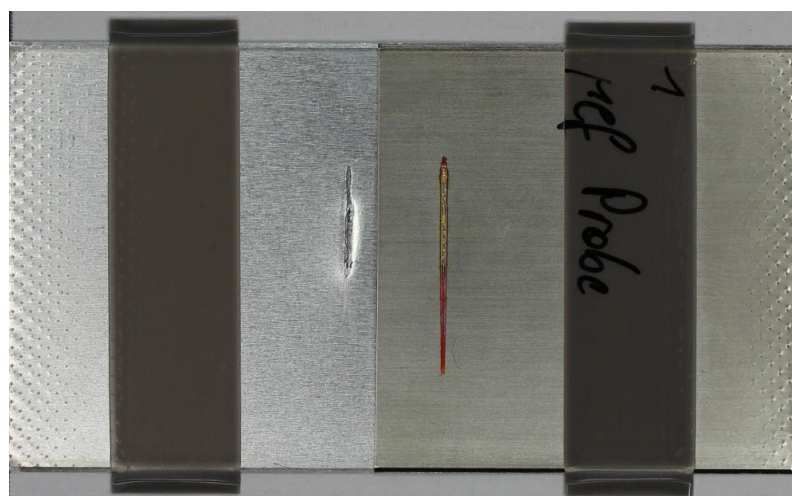
Bild 25: Referenzprobe nach Zugversuch
