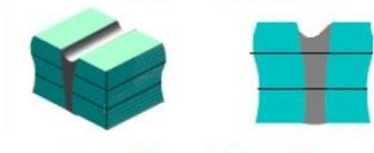
Bild A57: Schweißnahtfehler „Nahtunterwölbung“ [6]
