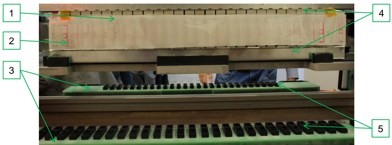
Bild 11: Spannvorrichtung während Druckverteilungstest an einem 27 Zeller Batteriemodul [18]
