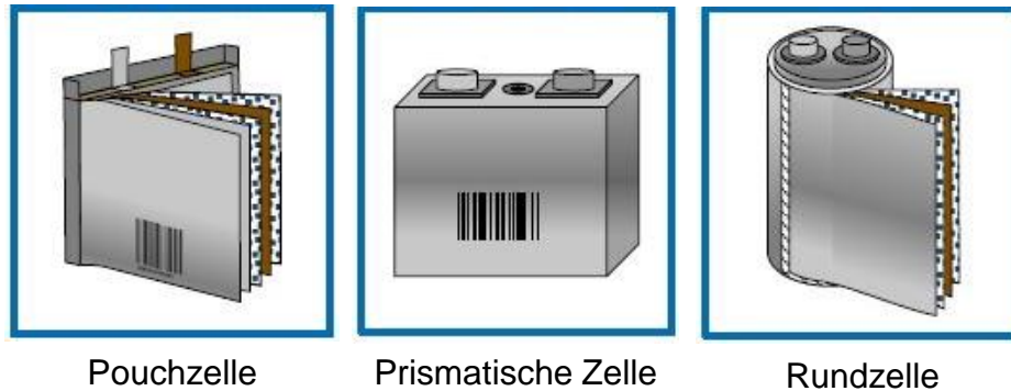
Bild 4: Verschiedene Zelltypen von Lithium-Ionen-Akkumulatoren [6]
