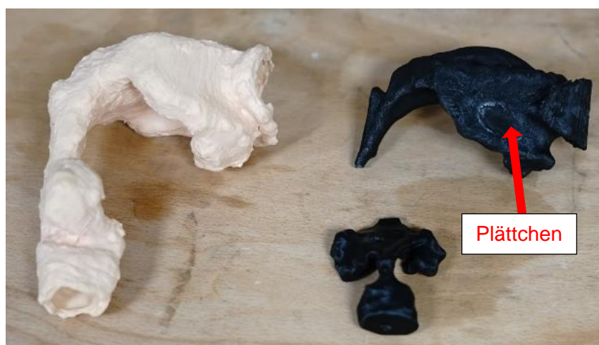
Abbildung 27: links Vokaltraktmodell aus Latex, rechts gebrochenes Negativmodell aus PLA
