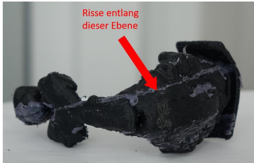
Abbildung 34: aus TPU gefertigtes 3D Modell des Vokaltraktes; viele Ebenen haften nur sehr schlecht aneinander, das Modell weist Risse auf
