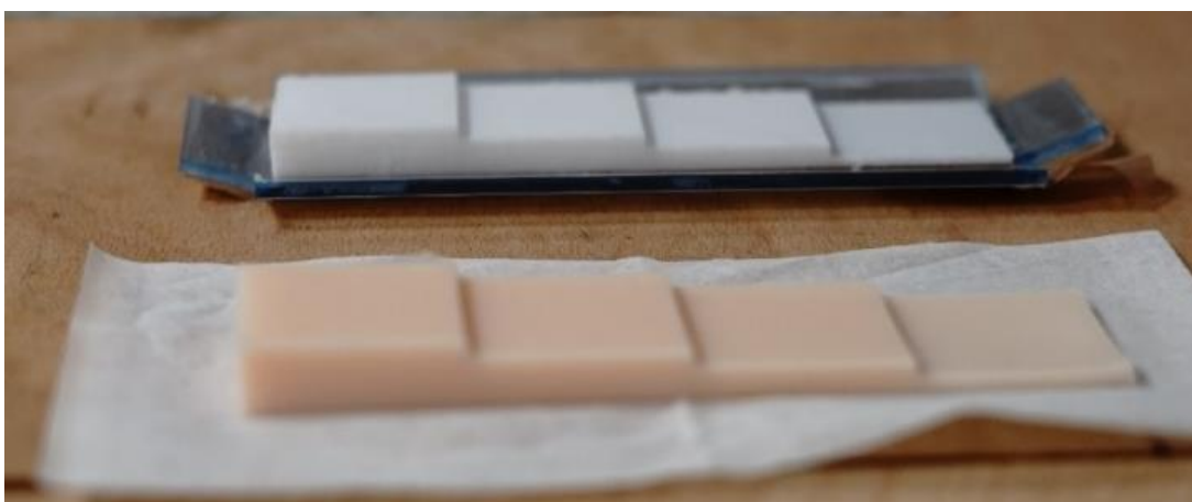
Abbildung 20: Materialtreppe in den Höhen von rechts: 2 mm, 4mm, 8mm und 11mm
