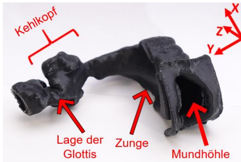
Abbildung 35: Aus PLA gefertigtes 3D Modell des Vokaltraktes mit Beschriftung der anatomischen Teilbereiche
