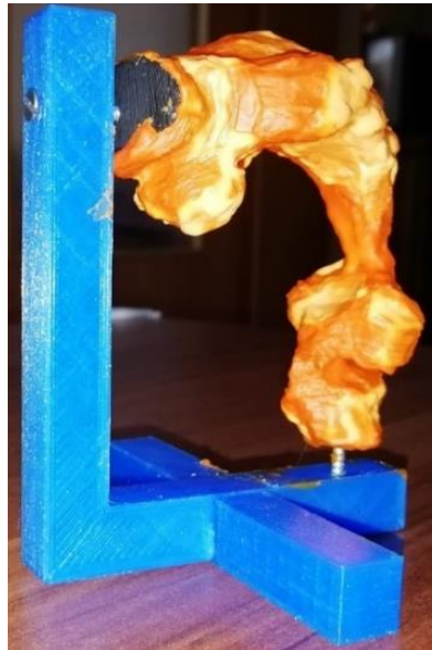
Abbildung 24: mit Latex überzogenes Negativmodell
