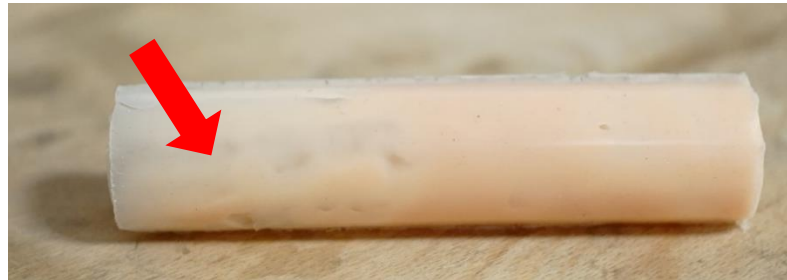
Abbildung 19: Zylinder 2 mit einer Länge von 110 mm und einer Wandstärke von 6mm; der rote Pfeil zeigt die Bereiche mit großen Lufteinschlüssen
