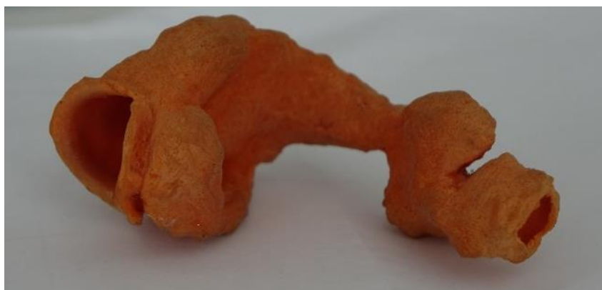
Abbildung 25: erster Prototyp eines positiven Modells des Vokaltraktes aus Latex
