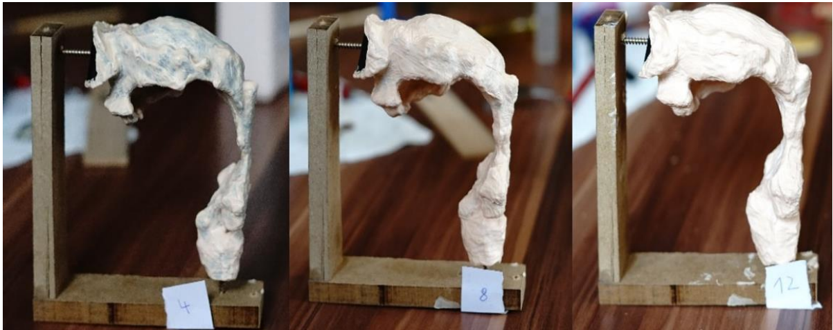
Abbildung 26: Fertigung des Originalmodell; links nach 4, mitte nach 8 und rechts nach 12 Anstrichen
