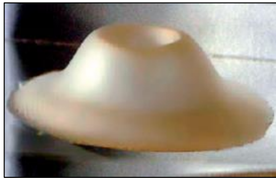
Abbildung 15: Einbrand in Plexiglas [M1]
