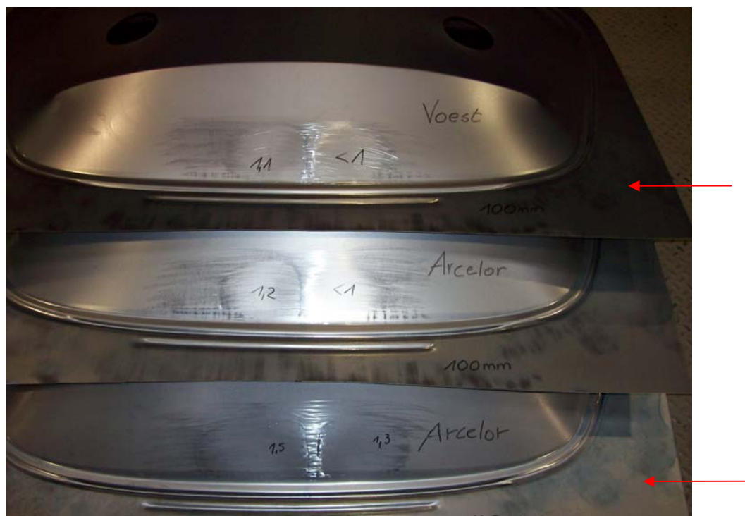
Abbildung 7.14: Faltenbildung 2.Ordnung in den verschiedenen Materialien
