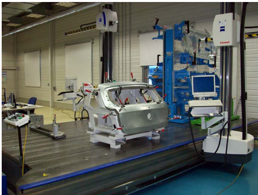
Abbildung 4.1: Koordinatenmessgerät Zeiss Carmet im Messraum bei Magnetto
