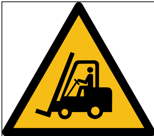
Anlage 36 Hinweisschild "W014 Warnung vor Flurförderzeugen" /ASTA-13/
