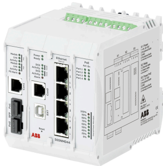
Abbildung 39: Frontansicht des Ethernet-DSL-Switch 500NMD44
