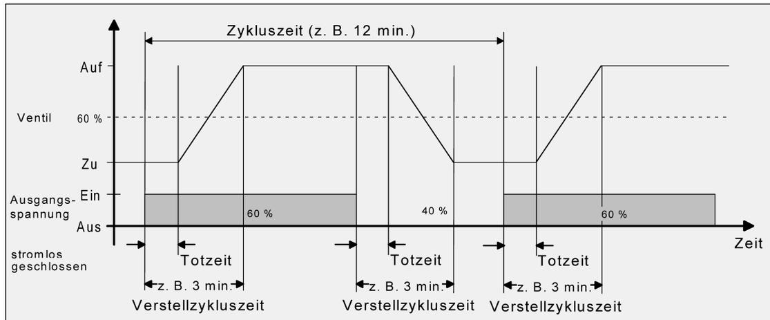
Bild 23: Idealisierter Verlauf des Ventilhubes exemplarisch dargestellt für eine Stellgröße von ca. 60 % eines stromlos geschlossenen Ventils
