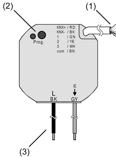
Bild 1: Geräteaufbau
