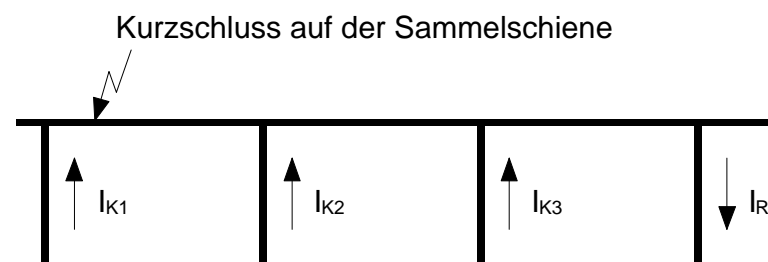
Abbildung 26 Sammelschienenfehler mit Durchgangsfehlerstrom I_R
