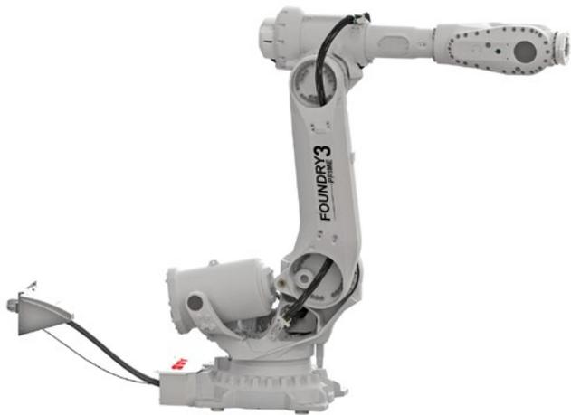
Der IRB 6790 ist der Roboter mit den niedrigsten Gesamtbetriebskosten seiner Klasse und wurde für anspruchsvolle Wasch- und Reinigungsanwendungen konzipiert. Er ist auf hohe Zuverlässigkeit in rauen Umgebungen ausgelegt und reduziert Wartungskosten um bis zu 60%.
