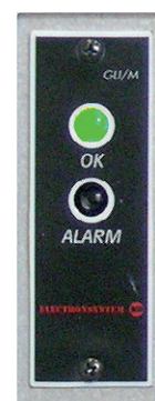
Abb. 7.12.3: Meldeleuchte für Gasdichte (Verwendung, wenn die Meldung nicht im Schutzgerät integriert ist)
