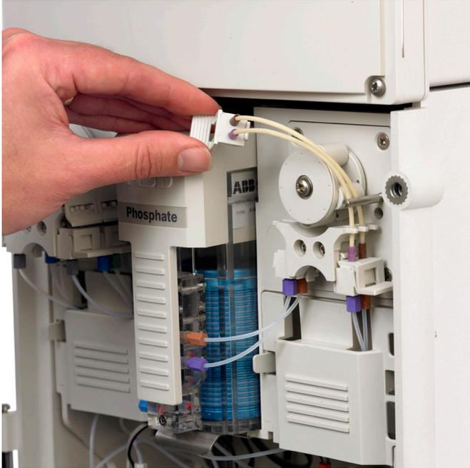
Abbildung 4 Einfach austauschbare Pumpenschlauchbaugruppen
