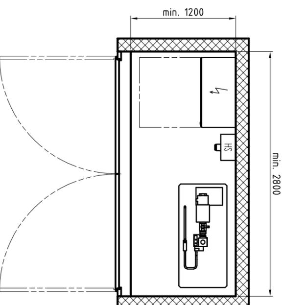
Maschinenraum Varianten, weitere Abmessungen oder MRL auf Anfrage
