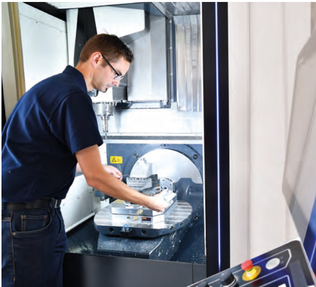
Für die Weiterbearbeitung des aus Titan gedruckten Sprunggelenkes für den Roboter der TU München, nutzt LIGHTWAY eine Fünf-Achs-Zerspanungsmaschine.
