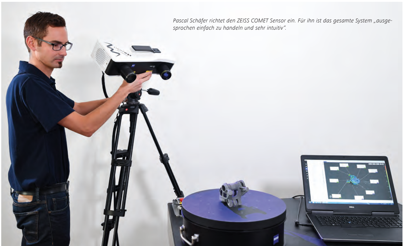
Nach dem Scannen lässt sich sofort prüfen, ob das erfasste 3D-Modell mit dem CAD-Modell übereinstimmt bzw. wo es Abweichungen gibt. Beim abgebildeten Sprunggelenk liegt alles im grünen Bereich.
