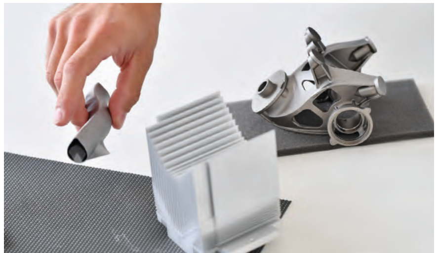
Das von LIGHTWAY konstruierte und gedruckte Lüftungselement enthält im Inneren einen Lamellenfächer und ließe sich mit herkömmlichen Fertigungsverfahren nicht herstellen und ersetzt vier ca. zehn Zentimeter hohe Aluminiumteile (unten im Bild). Das additiv gefertigte Roboter-Sprunggelenk (rechts) besteht aus Titan.
