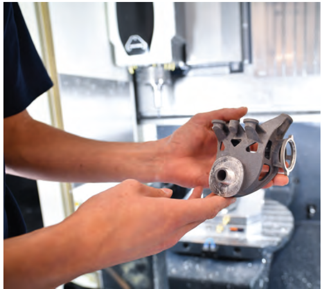
In das Sprunggelenk des Roboters wurden noch Gewinde eingebracht. Schäfer hält das Teil vor der Bearbeitungsmaschine in der Hand.
