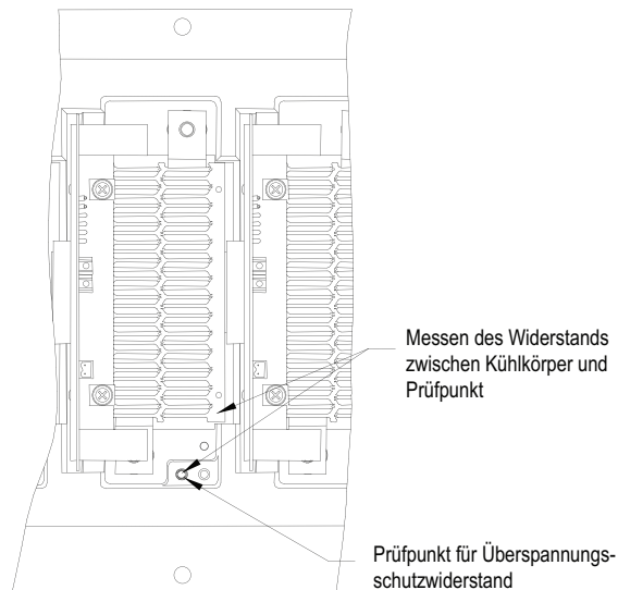
Abbildung 45 – Prüfen des Überspannungsschutzwiderstands
