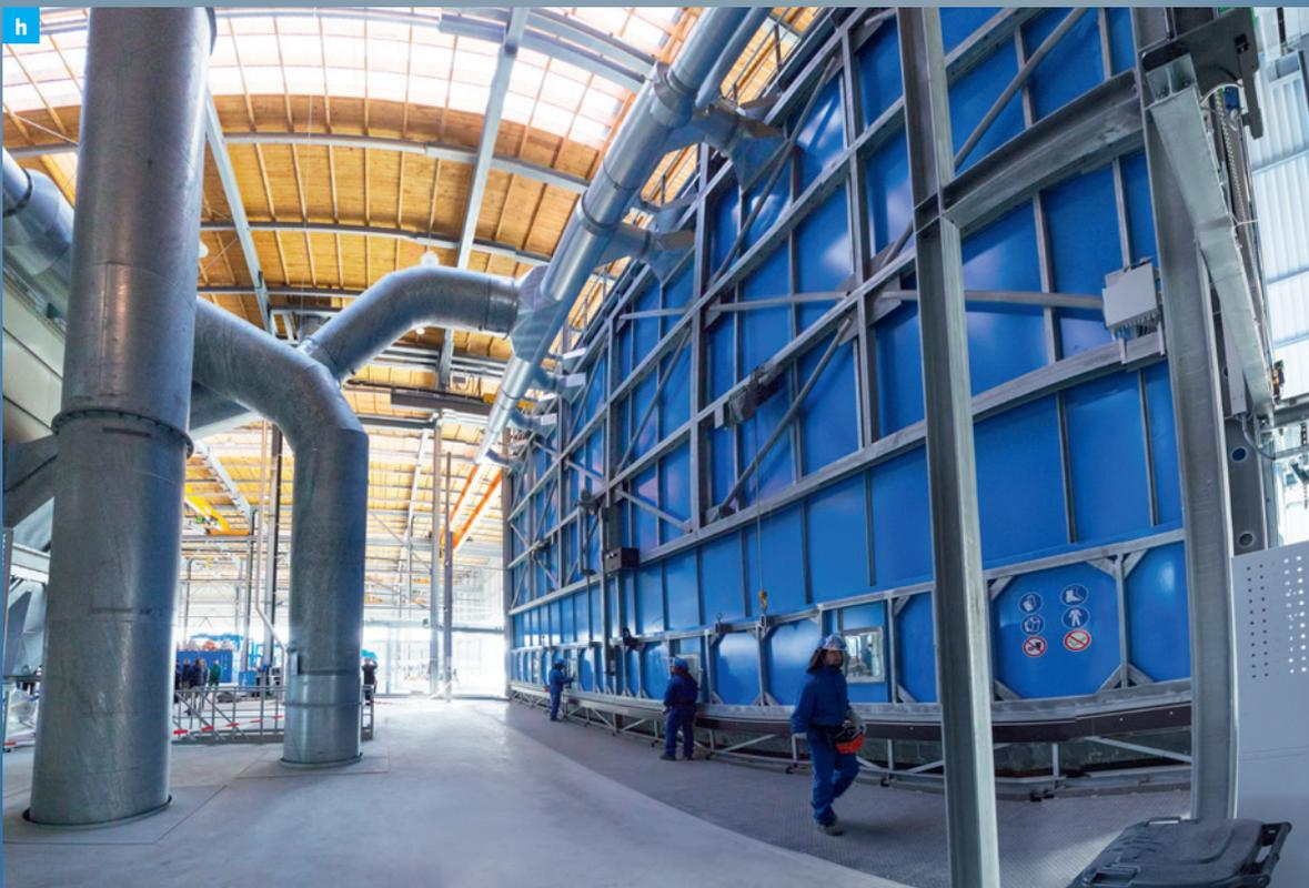
**h** Im mächtigen 17-m-Kessel unseres Werkes in Feuchtwangen können auch sehr lange Betonstahl-Armierungen und komplexe Bauteile aus Betonstahl wie z. B. Mattenkörbe, etc. feuerverzinkt werden.
