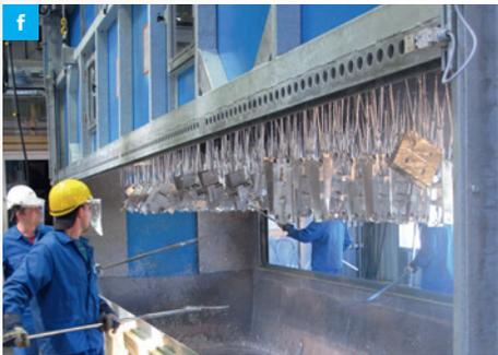
**f** Bevor das Zink zu erstarren beginnt, werden die Werkstücke gerüttelt, um Tropfnasen und zugelaufene Engstellen zu verhindern.
