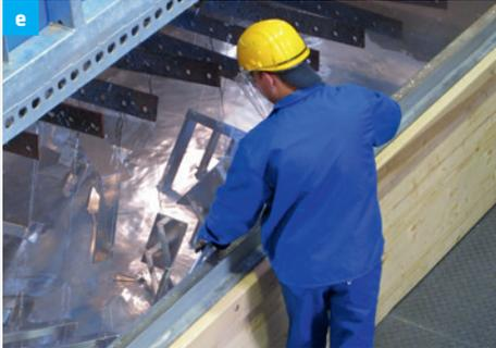
**e** Nach dem vollständigen Eintauchen in die Zinkschmelze und dem Aufwärmen auf die Temperatur der Zinkschmelze werden die Werkstücke langsam ausgezogen, damit das flüssige Zink wieder abfließen kann.
