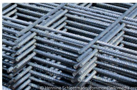
**Bewehrung:** Beton kann hervorragend Druckkräfte aufnehmen, weist jedoch eine geringe Zugfestigkeit auf. Deswegen wird Beton häufig mit Stäben oder Fasern aus Materialien hoher Zugfestigkeit bewehrt. Das können z. B. Stahlfasern, Glasfasern oder Fasern bzw. Bewehrungsstäbe aus Kohlenstoff (Carbon) sein.
