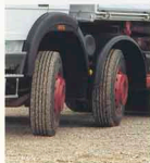
Zwei gelenkte Vorderachsen für Mobilität in jedem Gelände
