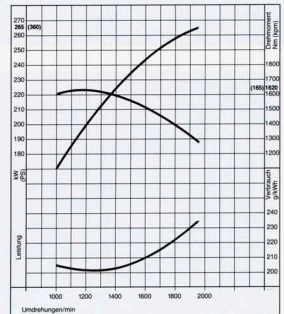
6-Zylinder-Viertakt-Diesel-Reihenmotor mit Direkteinspritzung, Turbolader, Ladeluftkühlung. Max. Leistung: 265 kW/360 PS bei 1950 U/min Max. Drehmoment: 1620 Nm bei 1100 U/min
