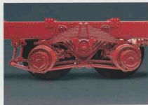
11-Blatt-Hinterfeder für 2 x 13 t Achslast
