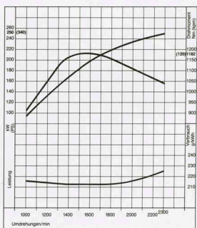
Luftgekühlter Viertakt-Dieselmotor mit Direkteinspritzung und Aufladung. Max. Leistung: 250 kW/340 PS bei 2300 U/min Max. Drehmoment: 1182 Nm bei 1500 U/min
