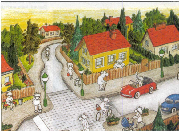
Abbildung 34: Fahrbahnanhebung im Kreuzungsbereich
