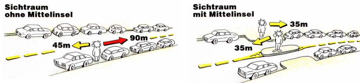
Abbildung 52: Erforderliche Sichtweiten mit bzw. ohne Mittelinsel (bei 50 km/h)
