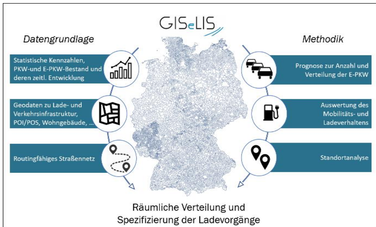
Abbildung 7: Funktionsweise des Standortmodelles für Ladeinfrastruktur GISeLIS
