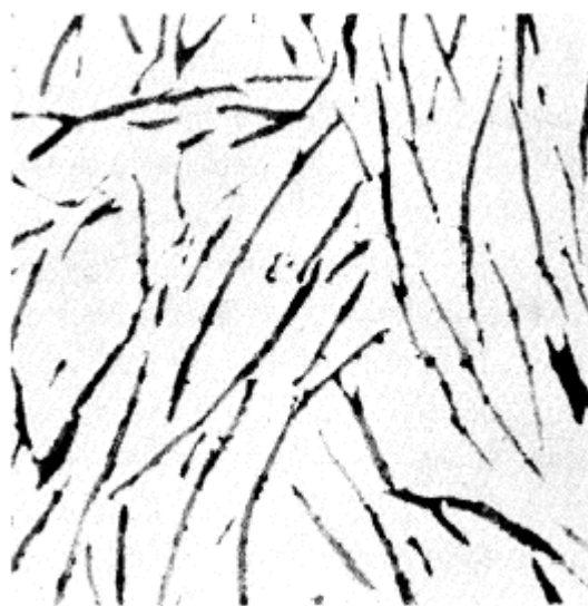
Figur 3.3 Mikroslip av grått støpejern med grove grafittlameller (mørke tråder). Polert, uetset og forstørret 50X.
