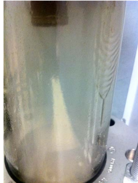
Aerosolbehälter Druck 7 bar Aerosol Tröpfchengröße < 1 \mu\text{m}
