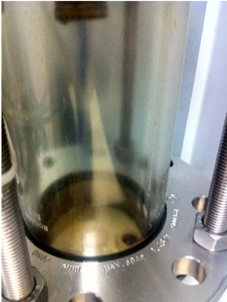
Aerosolbehälter Druck 0 bar kein Aerosol
