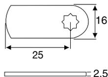
Riegel für Hebelschloss
