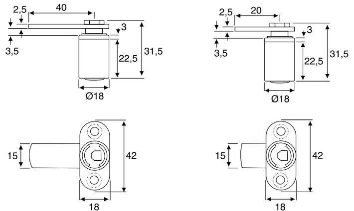
Hebelschloss zum Anschrauben
